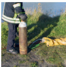
Gonflage de la barrière avec les languettes pour air comprimé
